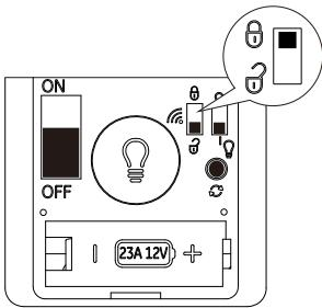
**En cas d'interférence avec plusieurs ventilateurs, il est possible de modifier le code de l'émetteur pour pouvoir actionner un seul ventilateur.**
